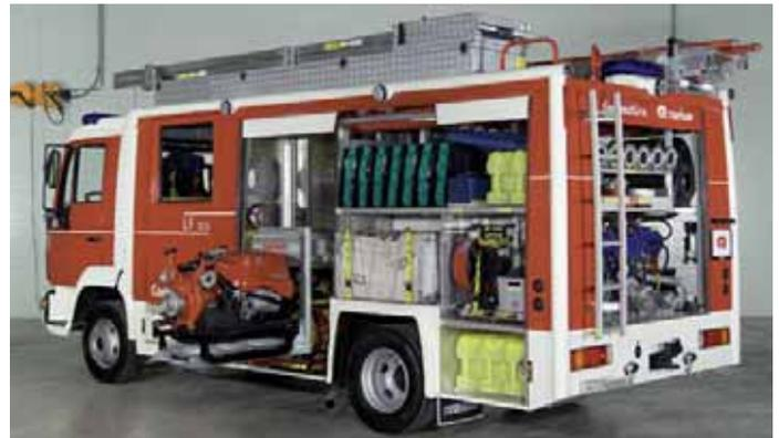
**Platzwunder.** Umfangreiche Ausstattung für den Löscheinsatz sowie für den technischen Einsatz. Das LF-B ist mit einer 200 Liter Poly-Löschanlage ausgerüstet mit der Fahrzeugbrände besonders effizient gelöscht werden können.
